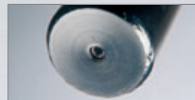
Einglassene Druckstufenverstellung durch Innensechskant / Compression damping adjustment by allen key
